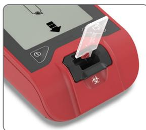
2 Placez la microcuvette dans l'analyseur.
